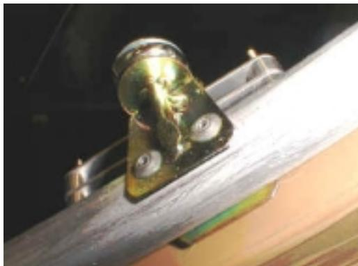
Vérifier que les rivets de fixation du système de fermeture verrière sur l'arceau sont des rivets de 4 mm de diamètre (8 rivets à vérifier : 2 dessus et 2 dessous de chaque côté).
